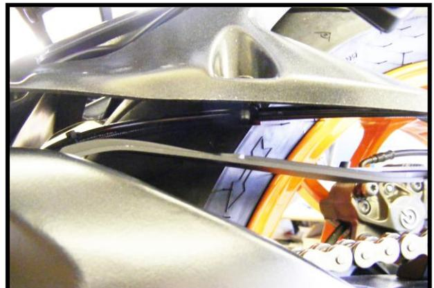
9. Beginnend mit Pos. 1 (siehe Bild) befestigen Sie die Abdeckung am originalen Kettenschutz mittels einer der M5x20 Schrauben und Muttern. Stellen Sie sicher dass die Schraube durch den Clip an der Bremsleitung geht.
