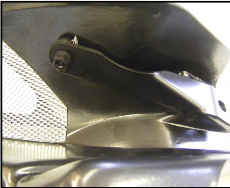
7. Befestigen Sie den Kantenschutz wie auf dem Bild zu sehen.
