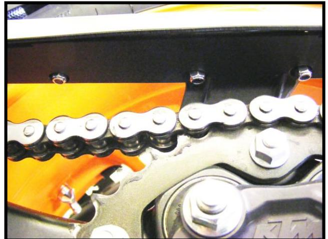
11. Befestigen Sie die Abdeckung mittels der 2 letzten M5x20 Schrauben an der Schwinge.
