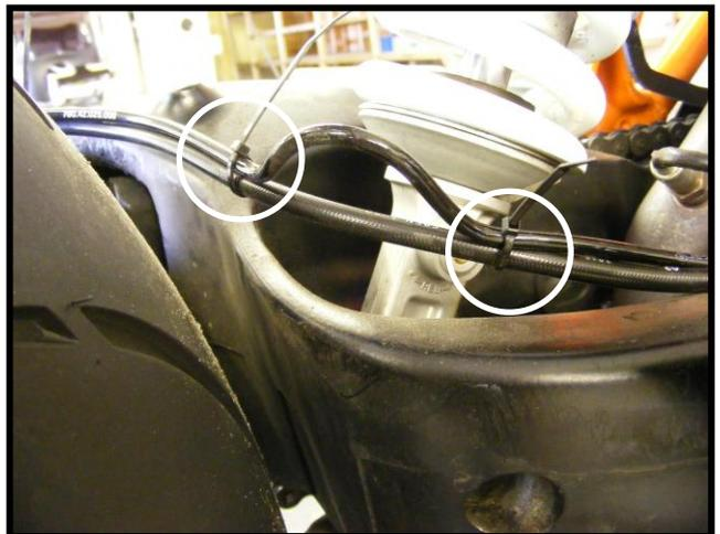
4. Montieren Sie nun den Clip über Brems- und ABS-Leitung
