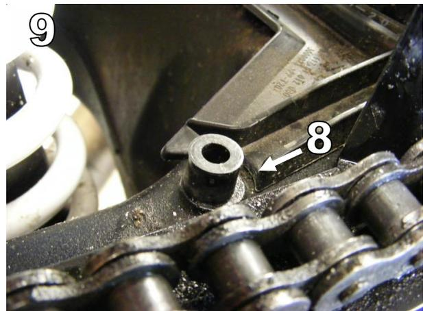
7. Befestigen Sie die Abdeckung auf der rechten Seite mittels M5x30 Schraube (7), 10mm Distanz (8) und M5x20 Schraube (5) Abb. 10+11./ Fit Hugger on right hand side using M5x30 screw (7), 10mm spacer (8) and M5x20 screw (5) Fig. 10+11
