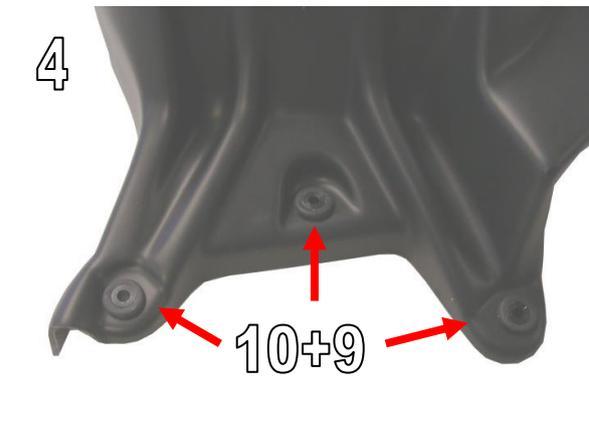
4. Befestigen Sie den Halter (2) auf der Innenseite des Kettenschutzes an der Hinterradabdeckung (1) mittels der 2 M6x20 Schrauben (6) und der 2 M6 Muttern (3) Abb. 5+6 / Fit bracket (2) to hugger shell (1) inside of chain guard using 2x M6x20 screw (6) and 2x M6 flange nut (3) Fig. 5+6
