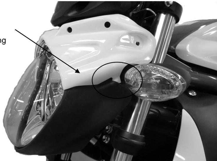
1. Demontieren Sie die beiden Original-Lampenverkleidungsteile
