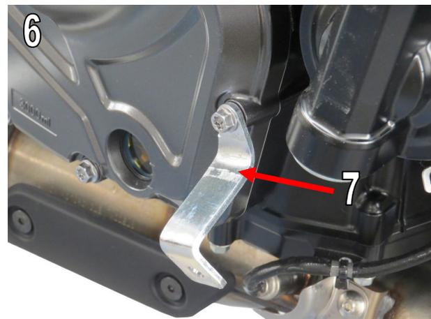
6. Montieren Sie den Bugspoiler an den Haltern mittels der M6x20 Schrauben (11) und der M6 Muttern (10). Sobald der Bugspoiler korrekt ausgerichtet ist, ziehen Sie bitte die Schrauben der Halter fest Abb.7+8 / *Fit Belly Pan to brackets using M6x20 socket screws (11) and M6 flange nuts (10). Once positioned correctly, fully tighten all brackets. Fig.7+8*
