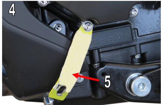
5. Befestigen Sie die rechten Halter am Fahrzeug unter der Verwendung der originalen Schrauben, ziehen Sie diese aber noch nicht fest Abb.5+6 / *Loosely fit the right hand brackets to the bike using the original screws Fig.5+6*
