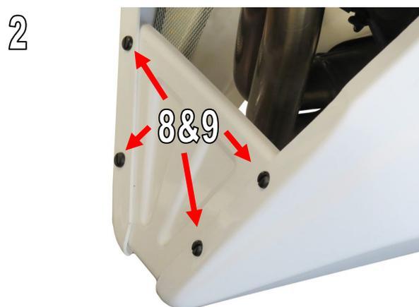
4. Befestigen Sie die linken Halter am Fahrzeug unter der Verwendung der originalen Schrauben, ziehen Sie diese aber noch nicht fest Abb.3&4 / *Loosely fit the left hand brackets to the bike using the original screws Fig.3&4*
