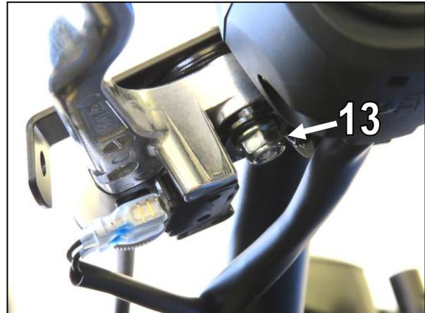
4. Setzen Sie die Gummiringe (6) und Stahlhülsen (7) in die Bohrungen der Handprotektoren ein. Befestigen Sie dann die Montageteile (8)-(12) zur Lenkerendbefestigung an den äußeren Bohrungen der Handprotektoren, setzen dies dann in das Lenkerende ein und befestigen Sie die Handprotektoren locker am Lenker.
