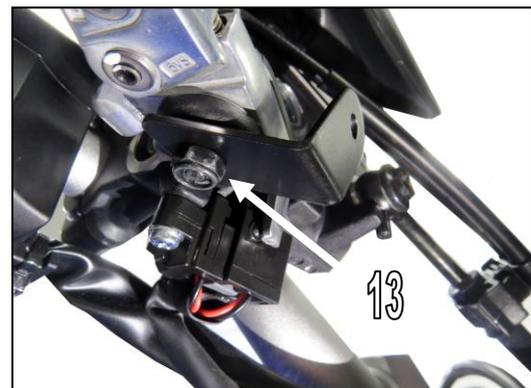
3. Demontieren Sie nun am Kupplungshebel die Befestigungsschraube, legen Sie zuerst eine U-Scheibe (9) und den Halter in Fahrtrichtung links (2) auf den Adapter und führen Sie die Originalschraube wieder komplett bis nach unten durch. Sichern Sie die Schraube mittels der M6 Mutter (13).
